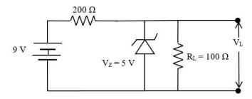
In the given circuit, find the voltage drop  $V_L$  in the load resistance  $R_L$ . প্রদত্ত বর্তনীতে লোড  $R_L$ -এ বিভব প্রভেদ  $V_L$ -এর মান কত ?
