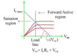
$$V_{CC} = I_C R_C + V_{CE}$$
