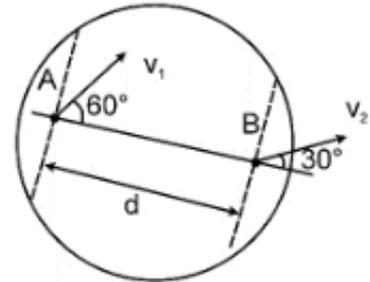
$$v_1 \cos 60^\circ = v_2 \cos 30^\circ$$
